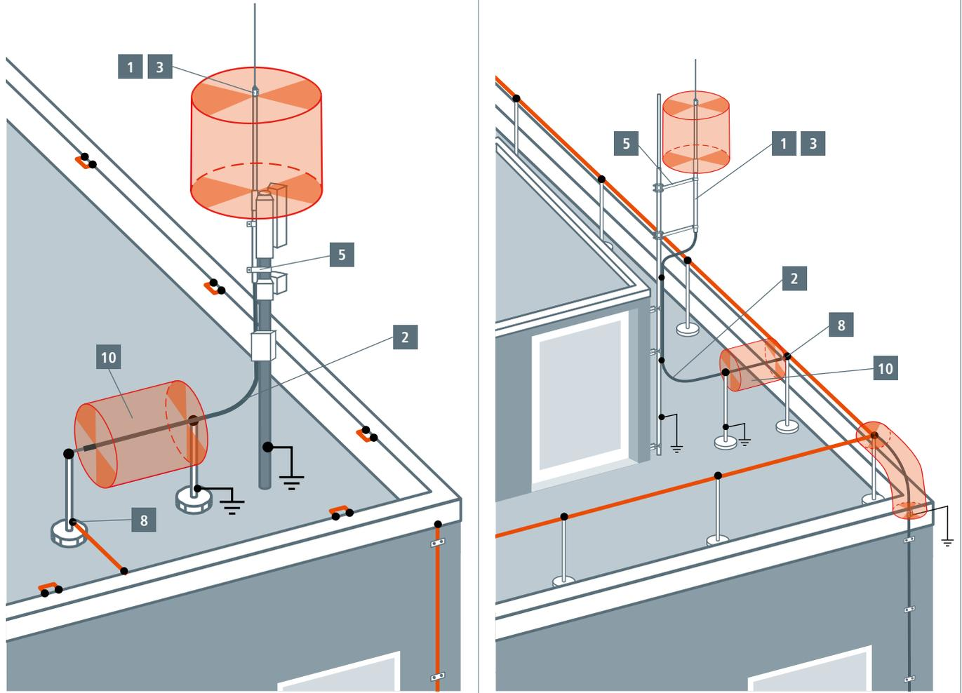
Montage HVI Leitung an einer explosionsgefährdeten Anlage
