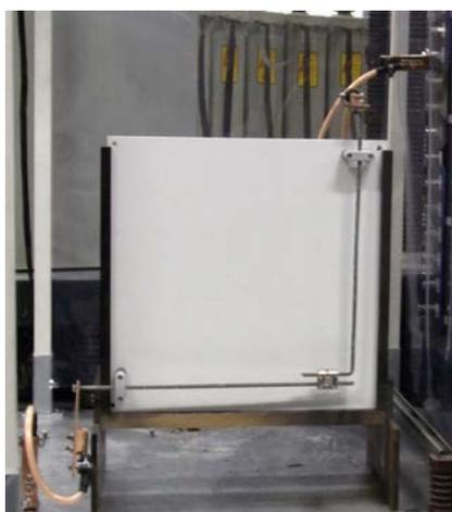
**Bild 5:** Auf Isolationstafel befestigter Prüfling (MV-Klemme) für Test im Stoßstromlabor.
