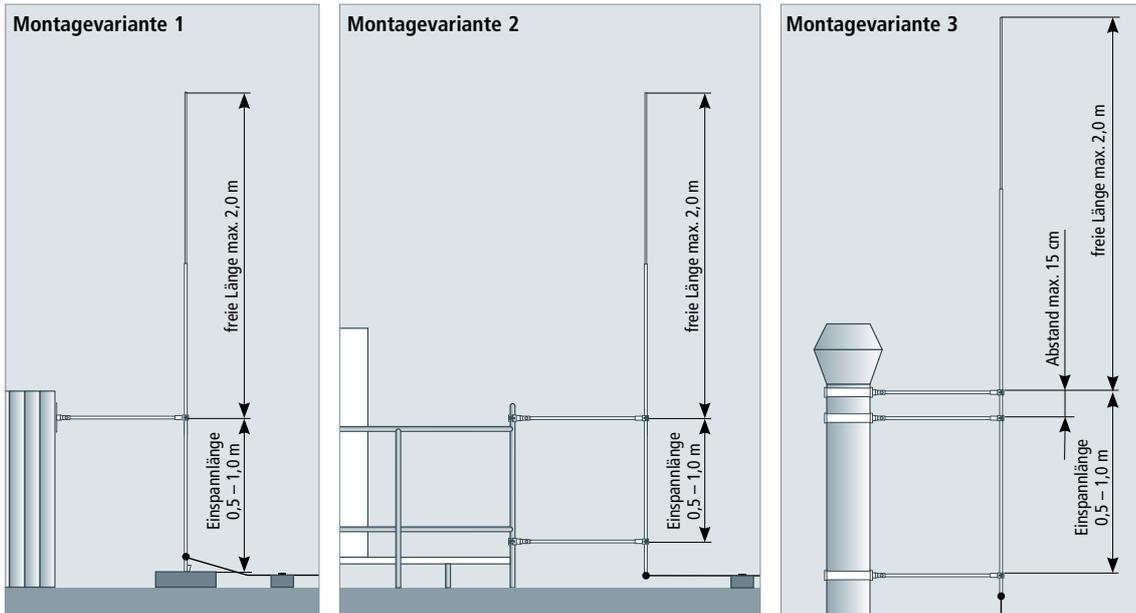
Variables Halterprogramm für Leitungen und Fangstangen zur Einhaltung des Trennungsabstandes nach DIN EN 62305-3 (VDE 0185-305-3). Distanzstab aus glasfaserverstärktem Kunststoff (GFK) Ø16 mm, UV-stabilisiert, Farbe lichtgrau.
